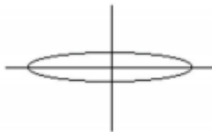
Qrafik 4. Kondensator VI əyrisi
